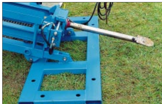
Gestänge-Haltevorrichtung mit Bohrlanze, Reinigungsabstreifer und Grundplatte
